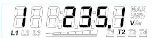
Obr. 3: Zobrazení aktuální hodnoty napětí ve fázi L1, T2 je aktivní tarif, přítomna pouze fáze L1
