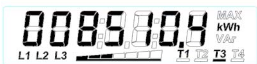
Obr. 2: Zobrazení energie v tarifu T3, T1 je aktivní tarif, bargraf indikuje odběr, všechny fáze přítomny
