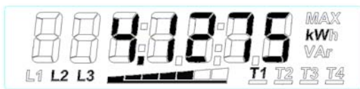
Obr. 4: Zobrazení okamžitého výkonu, T1 je aktivní tarif, bargraf indikuje odběr, chybí fáze L1
